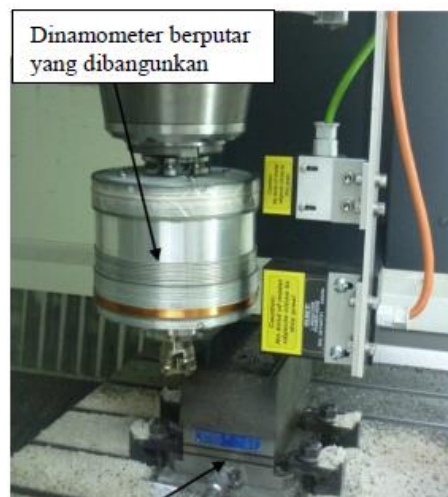
Rajah 2.19 Sistem penderia berbilang yang dibangunkan.
